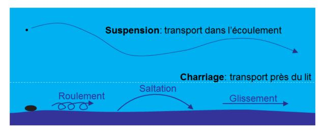
On appelle 'charriage' le flux de sédiments se déplaçant au contact du lit sous l'effet des forces hydrauliques. Il est responsable de la morphologie de la rivière. Il est difficile à mesurer et la solution alternative consiste à le calculer.
