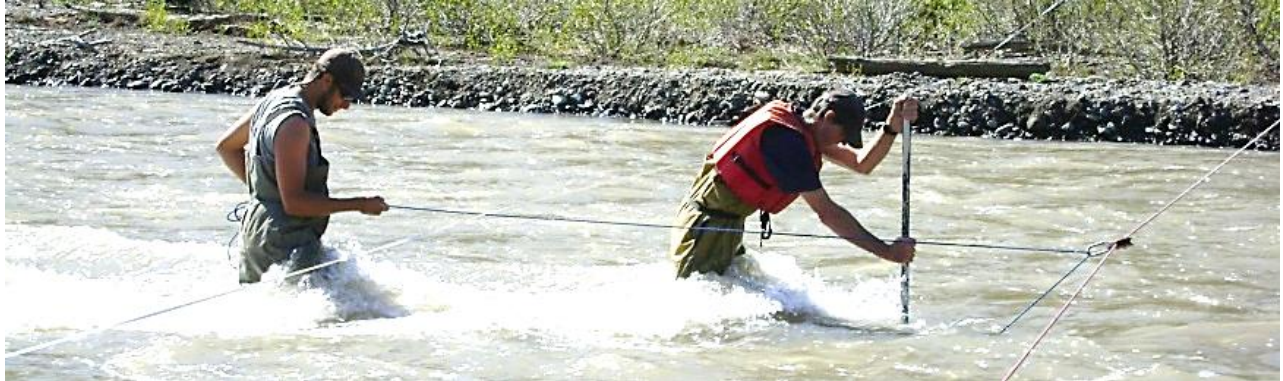
Figure 31: Système de rappel sur câble pour des prélèvements manuels: pendant qu'un opérateur descend le HS dans l'eau, le second opérateur tend un câble relié au HS via une poulie placée sur un autre câble tendu en travers de la rivière ; à l'arrière se trouve un mètre ruban également tendu en travers du cours d'eau pour le repérage de la verticale de mesure (photo John Pitlick).
