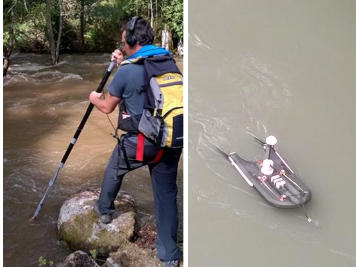
Figure 23: Ecoute du charriage avec l'hydrophone sur canne mobile, et sur radeau (EDF, Gipsalab)
