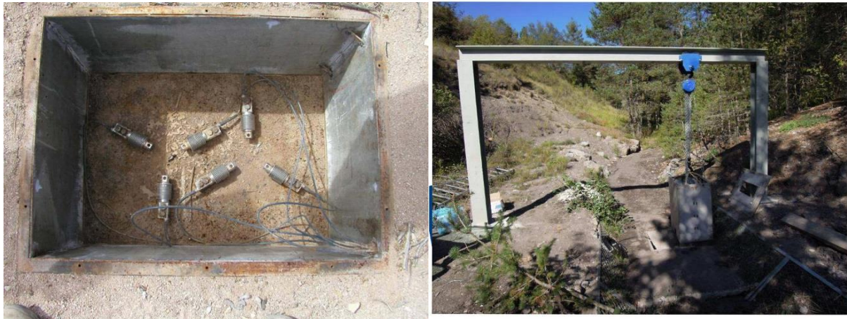
Figure 19: Trappe Birkbeck, capteurs de pression et portique de levage, sur le Moulin à Draix, France (Iristea, Photo F. Liébault).
