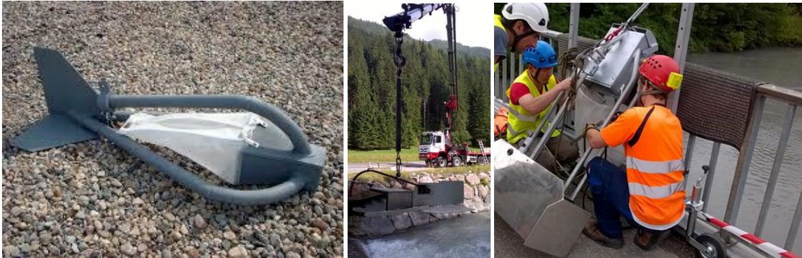
Figure 7: a) Le Helley-Smith, b) HS déployé depuis un camion (mesure EDF-Irstea sur l'Arve) c) le Toutle River 2 déployé depuis un pont sur l'Isère (Mesure EDF opérée par Hydrogéosphère sur l'Isère)
