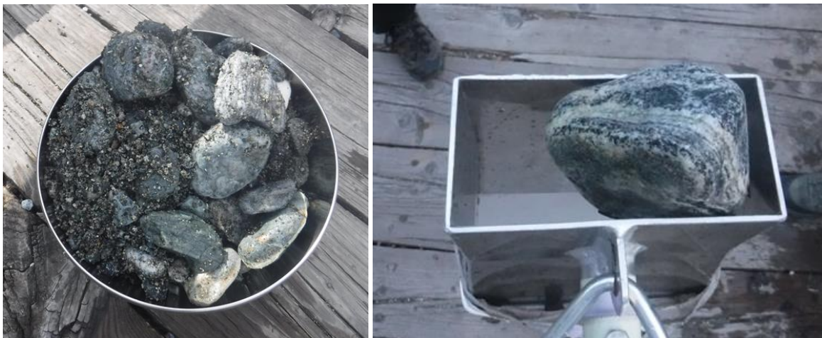
Figure 26: Cailloux mesurés au Elwha (monté sur canne et opéré à la main depuis un pont), et exemple de blocage du dispositif
